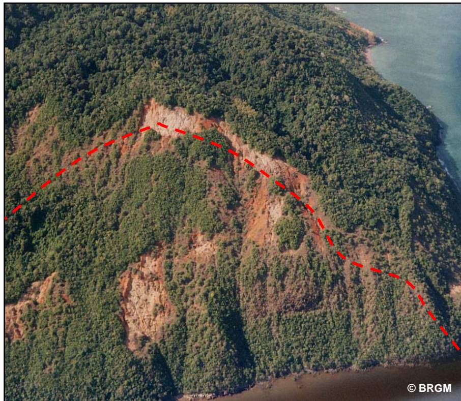
Glissement de terrain de grande ampleur, les argiles kaoliniques qui bordent systématiquement les massifs de phonolites sont fréquemment à l'origine de glissements profonds de versants, comme ici sur le Choungui de la commune de Tsingoni.
